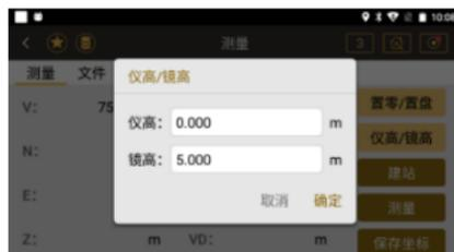
●仪高/镜高: 输入仪器高度和棱镜高度
