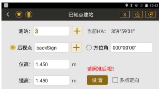
②设置测站点，通过[+]调用或新建一个已知点作为测站点。输入镜高和仪高。
