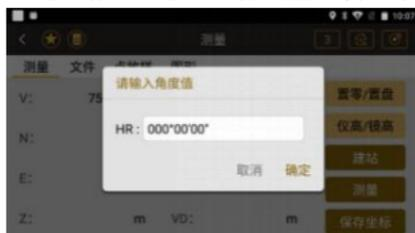
●置零/置盘界面, HR: 输入水平角度值
