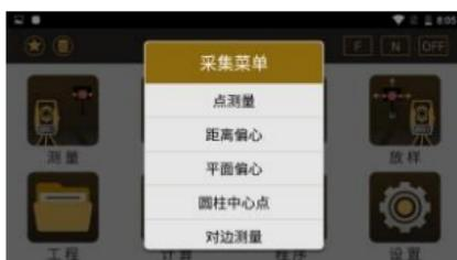
② 对准棱镜，在下方“左/右、前/后、上/下”一栏输入各个方向上棱镜与待测点的偏差值，然后点击测量/测存，即可获得待测点的坐标。
